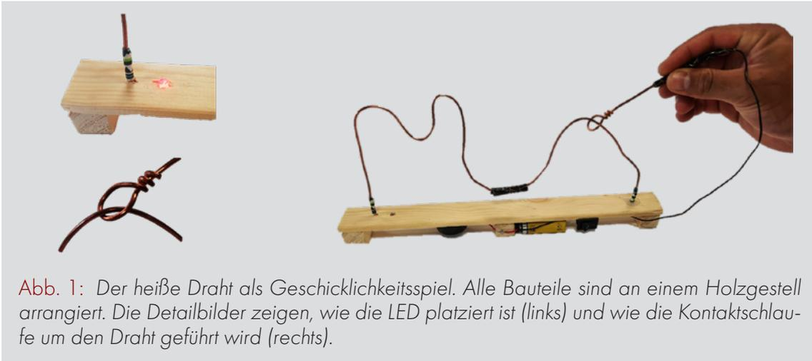
Dieser Effekt wird durch einen Stromkreis erzeugt, der nur geschlossen ist, wenn die beiden unbeschichteten Kupferdrähte des heißen Drahtes und der Kontaktschleife sich berühren. Der Aufbau ist in Abb. 2 zu sehen.
