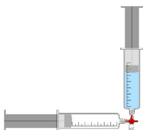
Eine Spritze wird mit 25 mL Wasser (Raumtemperatur) befüllt, die andere mit 30 mL Kohlenstoffdioxid. Über den Dreiwegehahn wird das Gas zum Wasser gegeben. Der Hahn wird verschlossen und die leere Spritze wird abgeschraubt.
