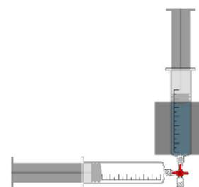
Der Versuch wird einmal mit deutlich kälterem oder deutlich wärmerem Wasser wiederholt. Dazu wird die Spritze **vorab mit einer Wärmeisolierung** überzogen, damit sich die Wassertemperatur während des Versuchs möglichst wenig verändert.
