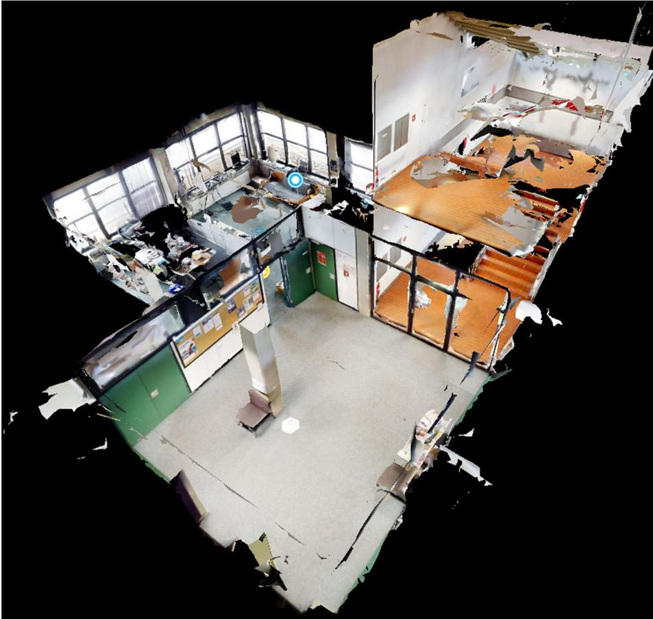
Abbildung 3: Resultierendes 3-D-Modell des beschleunigten Scanverfahrens
