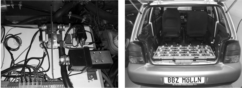
Abb. 4: Hochvolt-Stromkreis mit Sicherung und Lastschütz (links) und 10-kWh-LiFePo4-Batterie, bestehend aus 30 Einzelzellen (100 Ah, 3,7 V) mit BMS-Sicherheitsschaltung (nur für den Ladevorgang), im Kofferraum verbaut (rechts)
