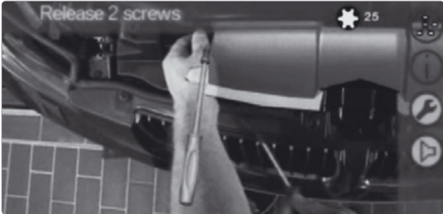
Abbildung 2: Argumented Reality im Kfz-Bereich 3 (Durch eine Brille werden Zusatzinformationen über das reale Bild gelegt.)
