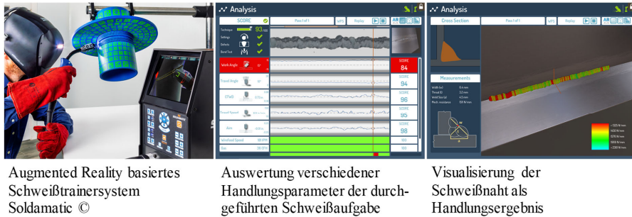
Abbildung 1: VWTs Soldamatic ©, Durchführung einer AR-Schweißaufgabe und Auswertung der Handlungsparameter. (Bildquelle: Seaberyat ©)
