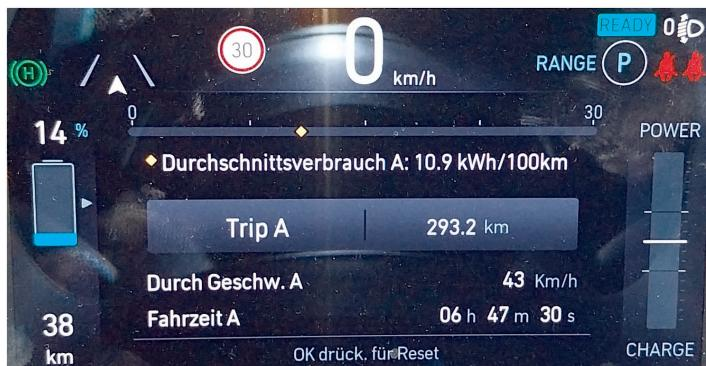
Abbildung 4: Display eines Elektroautos mit der Angabe des Durchschnittsverbrauchs
