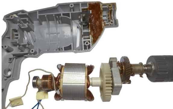
**Abbildung 2:** Handbohrmaschine als Demontageobjekt im Technikunterricht (eigene Darstellung)
