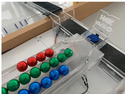
Abbildung 6: Die sortierten Kugeln werden nach Bestellung in die Transportbox gefüllt.
