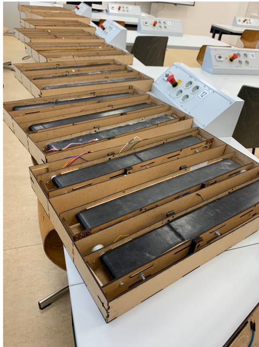
Abbildung 5: Foto einiger der eigenkonstruierten und eigenproduzierten Förderbänder
