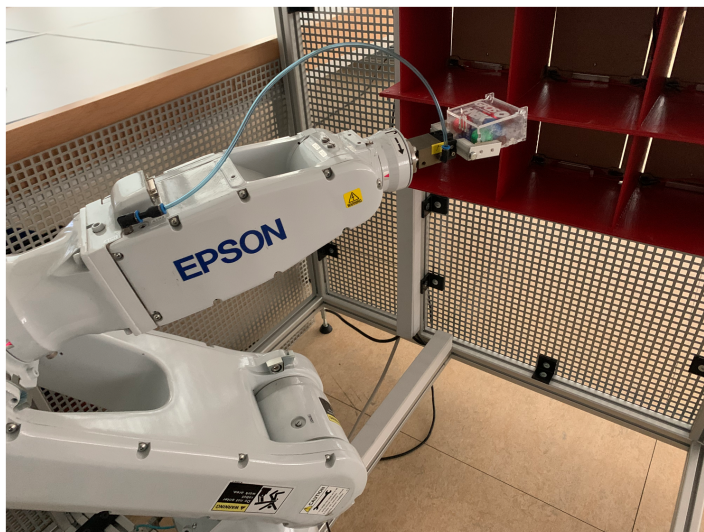
Abbildung 11: Das fertige Produkt wird in die Ausgabestation eingeräumt.
