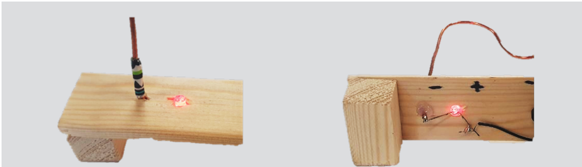
Abb. 5: So müssen der Kupferdraht und die LED später in das 5-mm-Loch passen.
