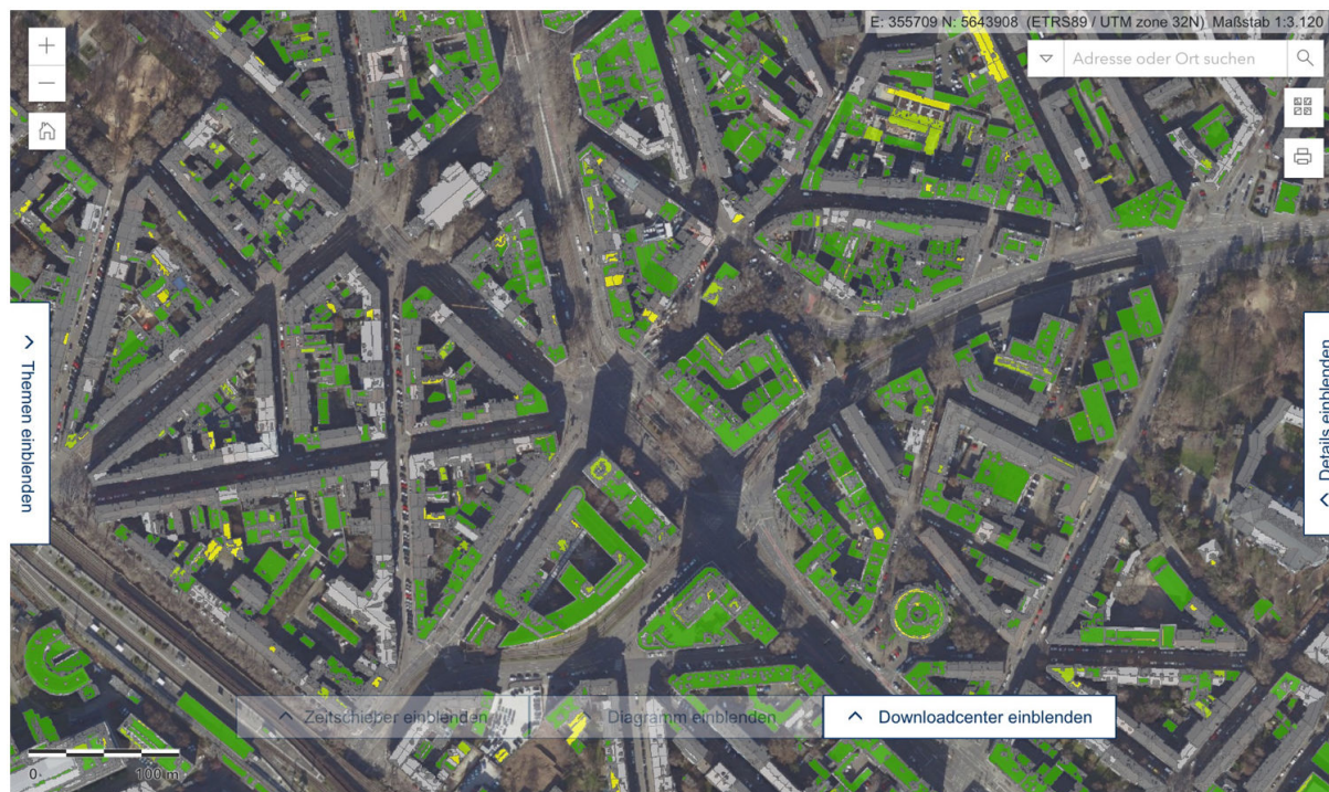
Abbildung 6: Beispiel einer in der Anwendungsaufgabe durchgeführten Analyse der potenziellen Eignung von Dachflächen für die Dachbegrünung mithilfe des Klimaatlas NRW, dargestellt am Beispiel des Zülpicher Platzes in Köln. In Grün: Dachflächen mit 0–5° Dachneigung
