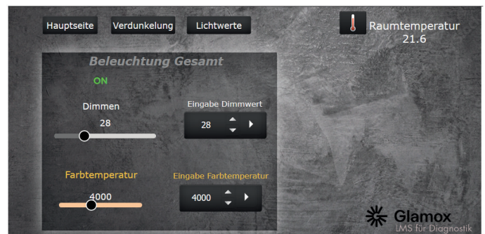
Abbildung 3: Darstellung auf dem Tablet zur Steuerung der Beleuchtungsstärke und der Farbtemperatur Quelle: Landesbildungszentrum für Blinde (Beschreibung siehe Abbildungs- und Tabellenverzeichnis mit Alternativtexten)
