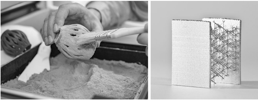
Abbildung 3: Mit 3DP gefertigtes Bauteil aus Aprikosenkernmehl (links; TUBAF) und plasmaelektrolytisch poliertes additiv gefertigtes Bauteil (rechts; BTE)
